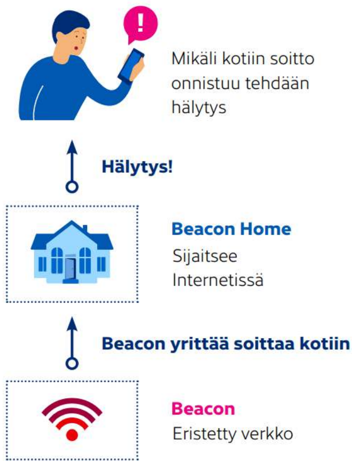
Kuva: SensorFu Beaconit testaavat ja hälyttävät eristettyjen verkkojen vuodoista.
