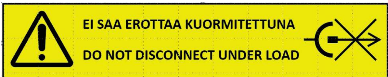
Kuva 1 – Varoituskilpi "EI SAA EROTTAA KUORMITETTUNA".
